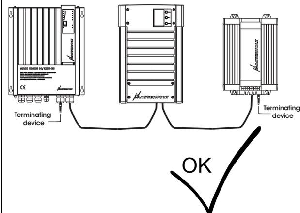
Der elektrische Strom für das Netz kommt von den angeschlossenen Geräten. Mindestens ein Gerät in dem Netz muss über Stromversorgungsfähigkeiten verfügen (siehe Spezifikationen). Ein Stromversorgungsgerät kann bis zu drei Nicht-Stromversorgungsgeräte versorgen. Da alle Stromversorgungsgeräte galvanisch getrennt sind, sind auch mehrere zulässig.
