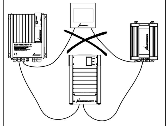
Führen Sie im Netz keine T-Anschlüsse durch.
