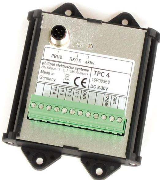
Das Temperaturinterface TPC 4 dient zum Anschluss von bis zu 4 Temperatursensoren an das philippi PBUS – System. Damit können bis zu 4 Temperaturen in Verbindung mit dem System-Monitor PSM 2 überwacht werden. Zusätzlich zu einer Alarmfunktion stehen am PSM 2 die jeweils tiefste und höchste Temperatur mit Zeitstempel zur Verfügung.
