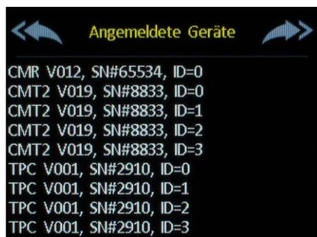
Sollten nach dem Geräte-Anmelden doppelte Geräte aufgelistet werden, muss die Funktion Geräteadressen erneuern aufgerufen werden um die Sub-Adressen der angeschlossenen und aktiven PBUS Komponenten zurückzusetzen.
