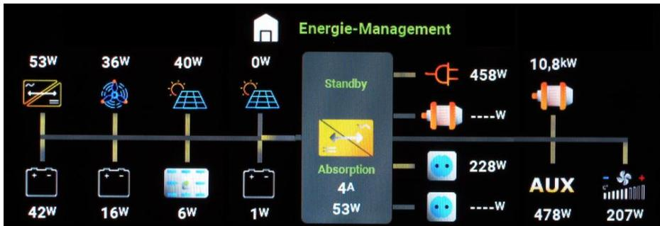
Die Ladequellen werden im oberen Teil dargestellt, die Senken (Verbraucher) und die Batterieanlage im unteren Teil.
