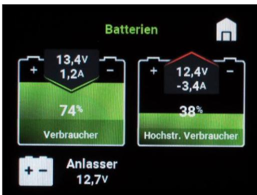
Erscheint in dem Batterie-Symbol die Meldung „Nicht synchronisiert“ dann wurde der Shunt SHC neu gestartet und die Anzeige der Batterie-Kapazität entspricht noch nicht
