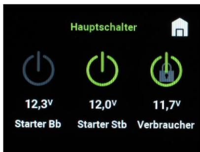
Falls zur Betätigung ein PIN notwendig ist, wird dies durch ein kleines Schloss angezeigt.
