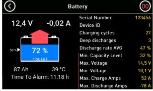
SHC im Betrieb durch vorzeitiges Erreichen der Tiefentladung erkannt dass die nominale Batteriekapazität z.B. durch Alterungseinflüsse nicht zur Verfügung steht, wird der nicht nutzbare Anteil durch einen dunkelgrauen Bereich dargestellt.
