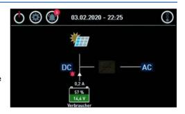
Die Ladequellen werden im oberen Teil dargestellt, die Senken (Verbraucher) und die Batterieanlage im unteren Teil.
