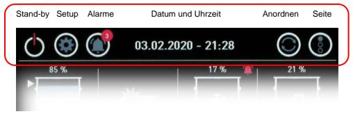
Zur Aktivierung des Standby-Modus muss der linke Button angetippt werden. Durch Antippen des Displays an jeder beliebigen Stelle geht der PSL wieder in den aktiven Betriebsmodus zurück.
