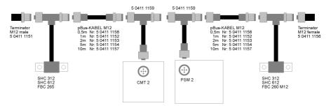
An den Endpunkten muss jeweils ein Abschlusswiderstand eingesteckt werden. Ohne die beiden Abschlusswiderstände ist der PBUS nicht funktionsfähig!
