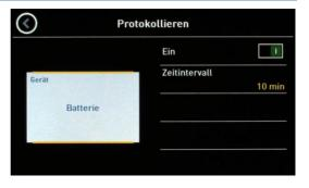
Ist die Protokollieren-Funktion aktiviert, kann die Zeitspanne zwischen zwei Log-Einträgen von 1 bis maximal 60 Minuten festgelegt werden. Für jede Gerätegruppe kann festgelegt werden, ob die Daten aufgezeichnet werden sollen.
