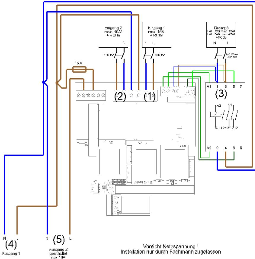
Der Schaltplan zeigt den Anschluss der Umschalteinheit LAU an 3 AC - Quellen. Die Eingänge 1, 2 und 3 der Umschalteinheit LAU müssen mit externen FI/LS-Schutzschaltern( RCBo) abgesichert sein.
