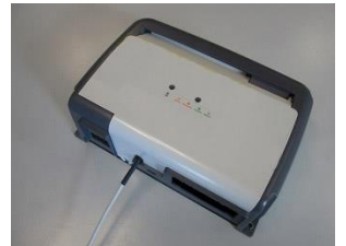
Einsetzen der Abdeckung und der Leitung.
