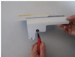
Einsetzen der Gummi-Kabeltülle
