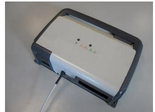
Einsetzen der Abdeckung und der Leitung.
