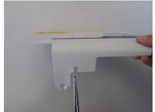
Ausbrechen der Metallzunge mit einer Flachzange
