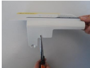
Ausbrechen der Metallzunge mit einer Flachzange
