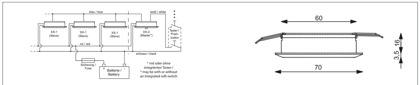
12V=24 Betriebsspannung 12 V und 24 V Gleichspannung (10 - 30 V DC)
