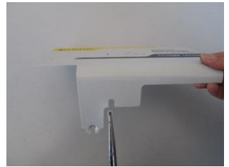
Ausbrechen der Metallzunge mit einer Flachzange
