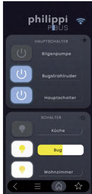
■ Schalten von Geräten Zu Fernzugriff freigegebene Geräte können hier geschaltet werden.
