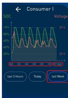
Die grün gezeichnete Linie zeigt den Ladezustand der Batterie und die grüne Farbe die Batteriespannung an. Mit dem Zeitpunkt des Öffnens der App und dem Batteriestatus in der Vorperiode.
