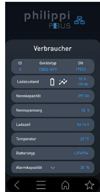
Batteriedetails eines einzelnen Batteriekreises
