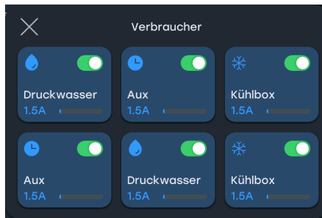
Verbraucher-Steuerung mit Stromverbrauch je Ausgang
