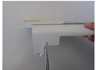
Ausbrechen der Metallzunge mit einer Flachzange
