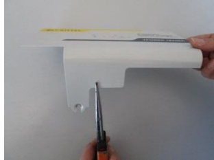
Ausbrechen der Metallzunge mit einer Flachzange
