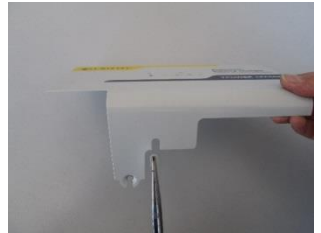
Ausbrechen der Metallzunge mit einer Flachzange
